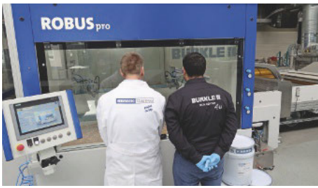
/ Im Bürkle-Technikum erfolgt der Lackauftrag mit der „Robus pro“, einer industriellen Spritzlackiermaschine.
